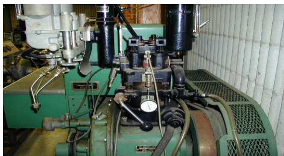
Fig.1. Motore CFR allestito al C.N.R.- istituto motori, nella sua configurazione originale.
